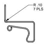
**CSP 528-1** SHN. OPP. **CLIP, INSULATION RETAINING**
