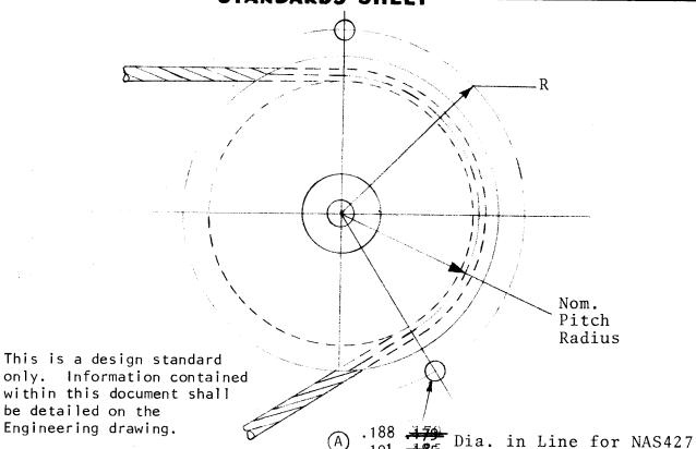
a) GUARD PIN LOCATION FOR STANDARD PULLEYS
